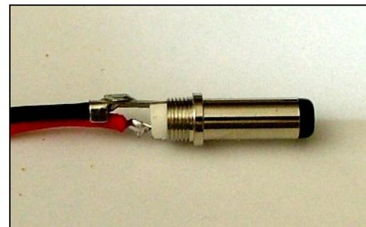
Es recomendable usar cable con dos colores, rojo y negro, para evitar accidentes. El cable debe ser apropiado para corrientes de 2 A; si va conectado a una batería puede ser apropiado incluir
