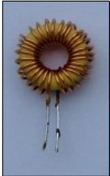
L1 y L4 – Corte aproximadamente 40 cm de hilo de calibre 27 SWG y pase la mitad del mismo a través de un núcleo toroidal T37-6. Esto cuenta como la primera espira. Ahora bobine otras 14 espiras en uno de los sentidos con un extremo del hilo, dé la vuelta al toroide y, con el otro extremo, haga otras 15 espiras hasta conseguir un total de 30 espiras. Mientras bobina, intente mantener el hilo tenso (o dé un pequeño tirón al terminar cada espira para que las espiras queden
