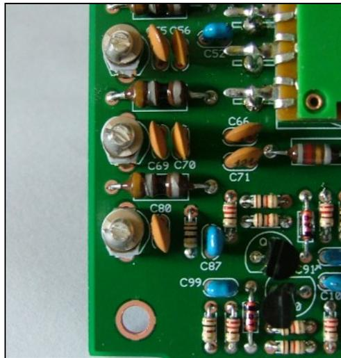
Corriente de polarización (bias) del paso final R2: Desconecte la antena y conecte una carga artificial capaz de soportar 5 W. Conecte un amperímetro en serie con el equipo y una fuente capaz de suministrar 3 A. Mientras hace los ajustes no haga ruidos ni hable por el micrófono. Pulse el PTT y apunte la corriente consumida. Ajuste R2 para conseguir un aumento
