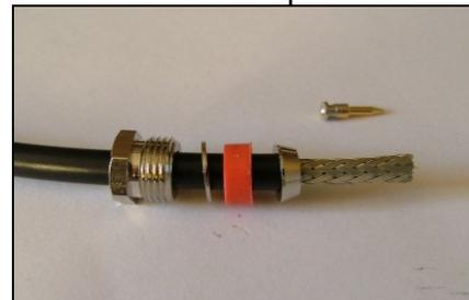
Inserte por el extremo del cable RG58 la tuerca de compresión, la arandela, y el sello. Recorte unos 15 mm de la cubierta externa del cable e inserte el collar cónico.
