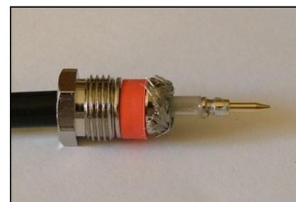
Coloque el contacto interno y súeldelo a través del pequeño orificio.
