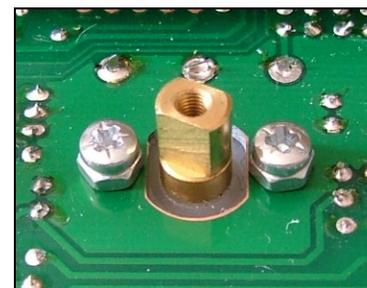
Instale el condensador de sintonía utilizando tornillos M2.5 x 6mm. NOTA: Debe colocarse una tuerca en cada tornillo justo debajo de la cabeza para evitar que se meta demasiado en el condensador variable y pegue con las placas del condensador.
