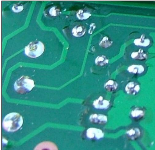
el recubrimiento dado al circuito para facilitar la soldadura.
