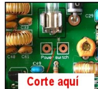
Se puede incorporar un interruptor intercambiando el potenciómetro de ganancia de RF por uno similar con interruptor, cableándolo a las isletas. Deberá cortar con una cuchilla la pista que las une, tal como puede verse en la foto.
