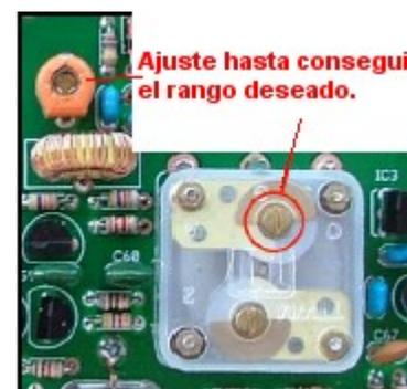
antihorario hasta el tope (frecuencia mínima) y ajuste C38 para que la frecuencia mostrada sea ligeramente inferior al extremo inferior de la banda: se sugiere 3.450MHz. Gire el mando hasta la frecuencia máxima y compruebe que es posible llegar por encima del extremo superior de la banda. Si así se desea, se puede ajustar el rango total de sintonía con el trimmer situado en la parte trasera
