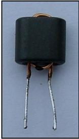
L3 – bobine 2 espiras de hilo de calibre 27 SWG a través de los orificios de un núcleo binocular pequeño BN43-2402.
