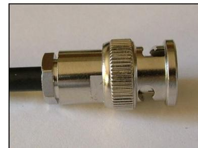
Coloque el cuerpo y apriete la tuerca de compresión. Compruebe que no hay cortocircuitos y que el contacto interior está en la posición correcta.
